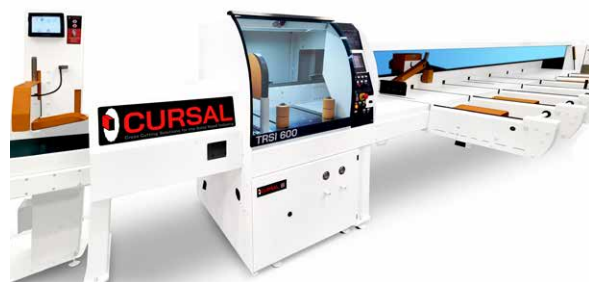
□ Čelilnik z optimizacijo TRSI Ø600 CUTTING 90°
