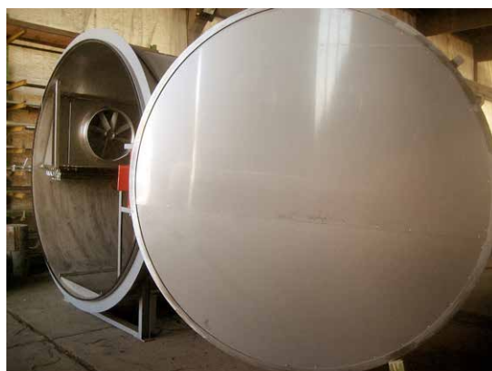
□ Vakuumska sušilnica Kronseder KVT 1500 pri stranki Štrukelj, Šempas, Slovenija
