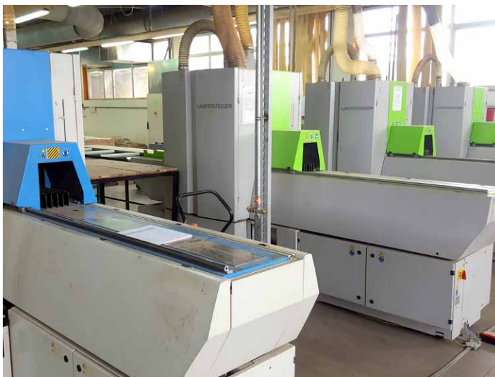
□ Tankorezni polnojarmeniki Wintersteiger DSG Sonic pri stranki Bjelin Ogulin, Hrvaška
