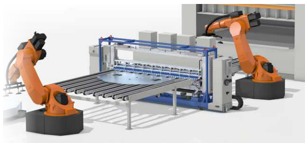
□ Evomat® za čiščenje štancanih elementov
