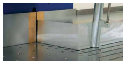
□ Žaganje brez (zgoraj) in s CLEAN-UP sistemom (spodaj)
