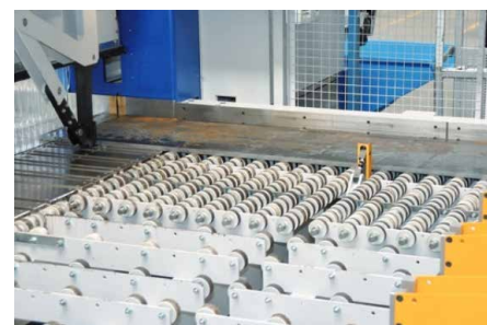
□ Natančno pozicioniranje z vpenjalnimi kleščami
