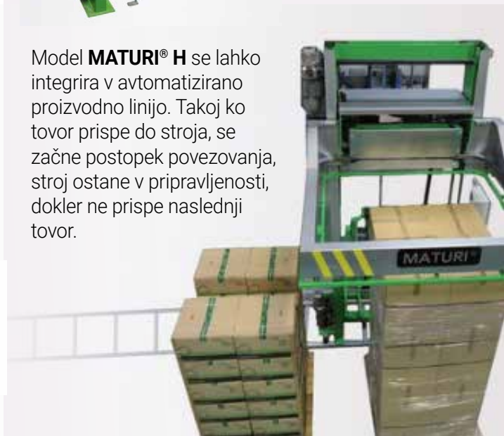
□ Kosi se povežejo tako, da se prepreči drsenje in premikanje izdelkov.
