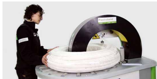
□ Model Artemis za ovijanje okroglih izdelkov s folijo
