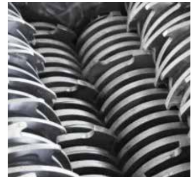
□ 2 rezalni in 2 čistilni gredi
