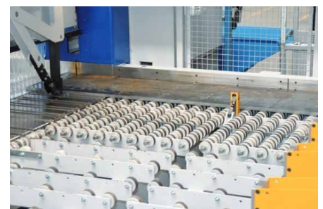
□ Natančno pozicioniranje z vpenjalnimi kleščami
