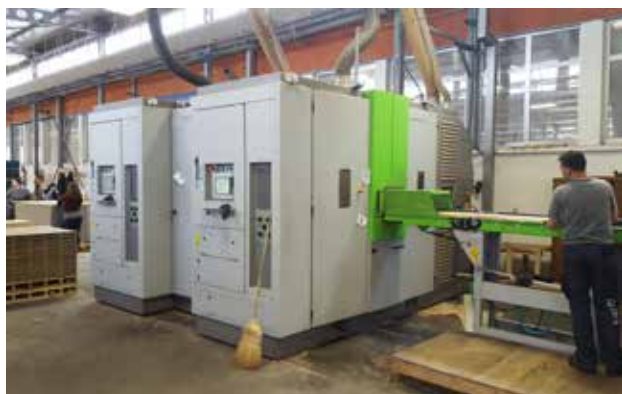
□ Tankolisna tračna pila DSB Twinhead s dva modula u tvornici Bjelin Bjelovar, Hrvatska
