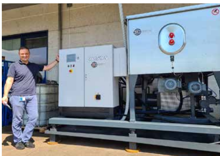
□ Stroj za izradu briketa od ostataka aluminija Weima TH800 AL u tvornici KOVIS Brežice, Slovenija
