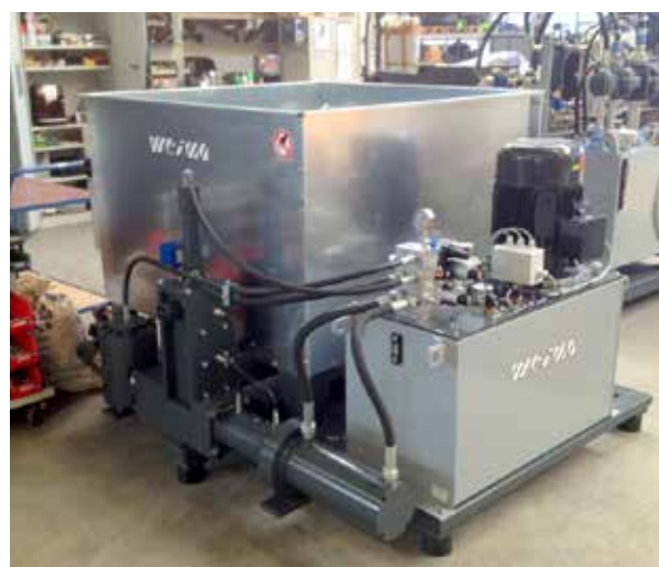
□ Stroj za proizvodnju briketa od plastičnih materijala Weima TH814 u tvornici Weima prije isporuke u SMITHERS OASIS ADRIA, Gradac, Slovenija
