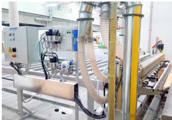
□ Konzolne krtiče za čišćenje površina Wandres UNA X321 u tvornici ADRI MOBIL, Novo mesto, Slovenija .
