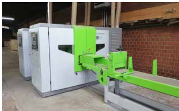
□ 2 tankolisne tračne pile DSB Singlehead NG XM 350 u Drvoprodukciji Jastrebarsko, Hrvatska
