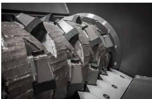
□ Rotor WKS je obložen z zaščito iz vautida , ki ščiti pred abrazivnimi materiali
