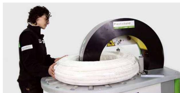
□ Model Artemis za ovijanje okroglih izdelkov s folijo
