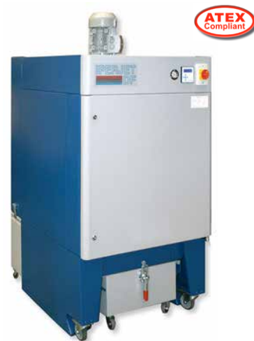
□ Filter IperJet DF za odsesovanje varilnih hlapov
