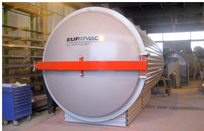
□ Vakuumske sušilnice KRONSEDER Eurovacs prostorninami od 1,5 do 60 m 3
