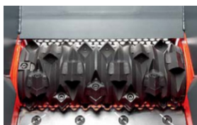
□ Stroj za drobljenje WL 4 z zaobljenim zalogovnikom in V rotorjem
