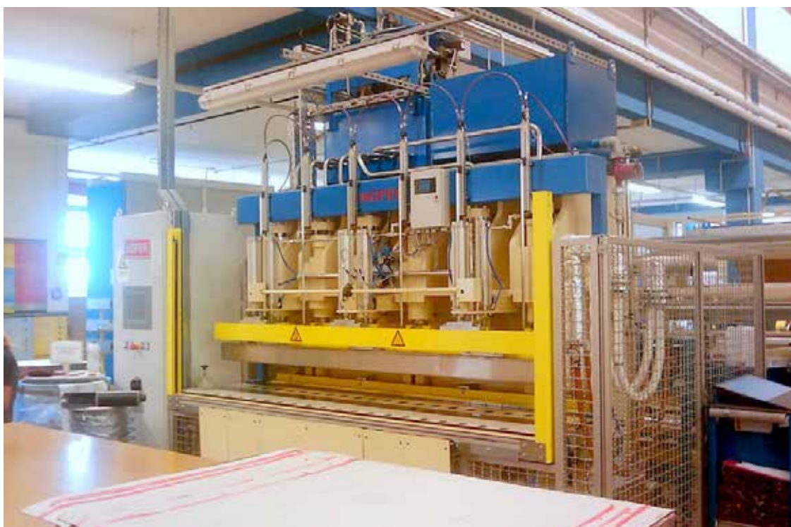
□ Specialna stiskalnica za letvičenje Höfer pri stranki Savatech d.o.o. Kranj, Slovenija
