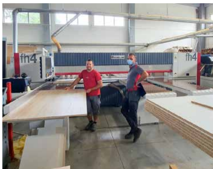
□ Stroj za krojenje plošč Schelling fh4 pri firmi ELEKTROMETAL, Kaštelir, Hrvaška
