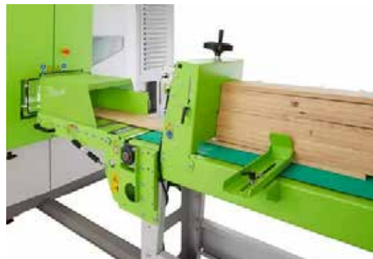
□ Vstavljanje več blokov lesa v podajalnik omogoča vzporedno upravljanje več strojev oz. delovnih procesov
