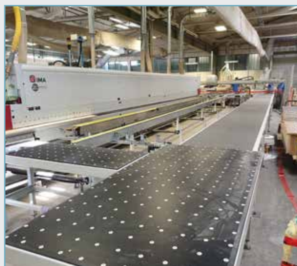
□ Stroj za obdelavo robov Ima Novimat Systems I/R75/950 skupaj s sistemom za vračanje obdelovancev BARBARIC Return 02 pri stranki PODGORJE Šentjernej, Slovenija
