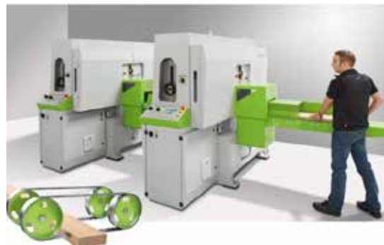
□ Konstrukcija stroja DSB Compact 310 omogoča postavitev dveh ali več strojev v liniji.
