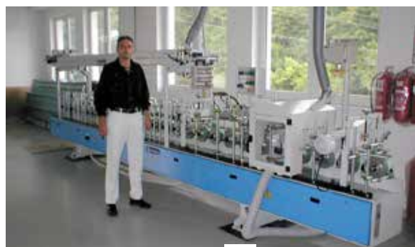
□ Stroj za oplaščenje profilov Barberan RP 30 pri stranki KUMPLAST, Zagorje, Slovenija
