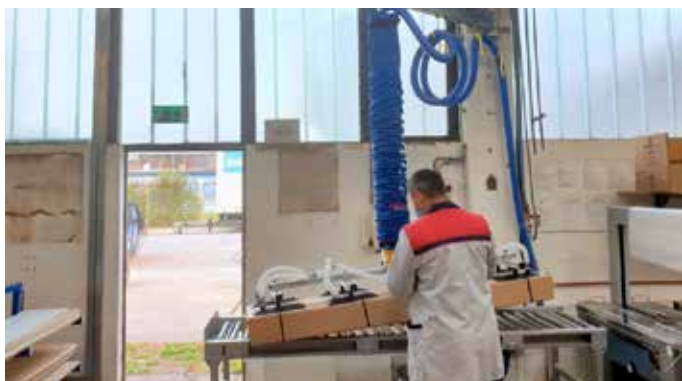
□ Dvižna naprava Fezer VPL pri stranki KOLPA, Metlika, Slovenija
