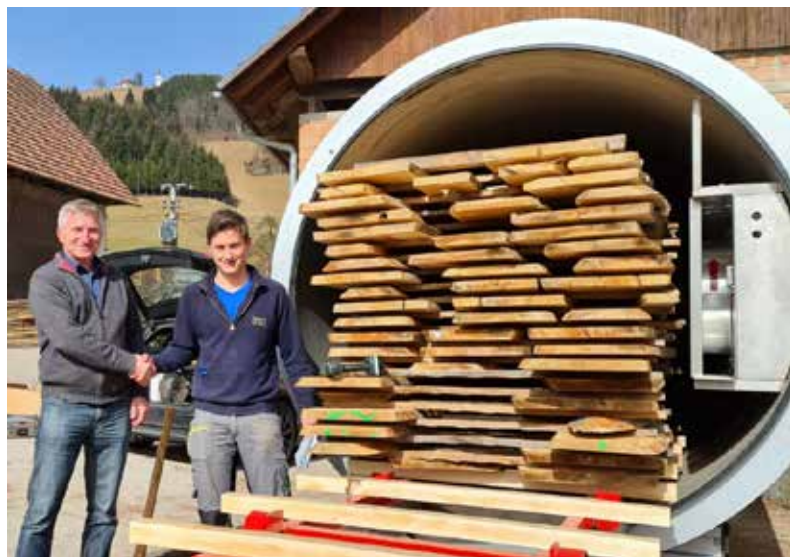
□ Vakuumska sušilnica Kronse der Eurovac KVT 1800 pri stranki Žagarstvo Sedej, Rovte, Slovenija
