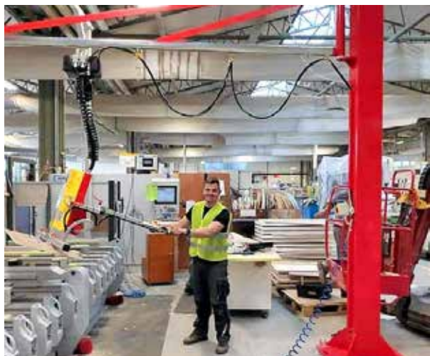
□ Naprava za vakuumsko manipulacijo Barbaric UniWood pri stranki PODGORJE Šentjernej, Slovenija .
