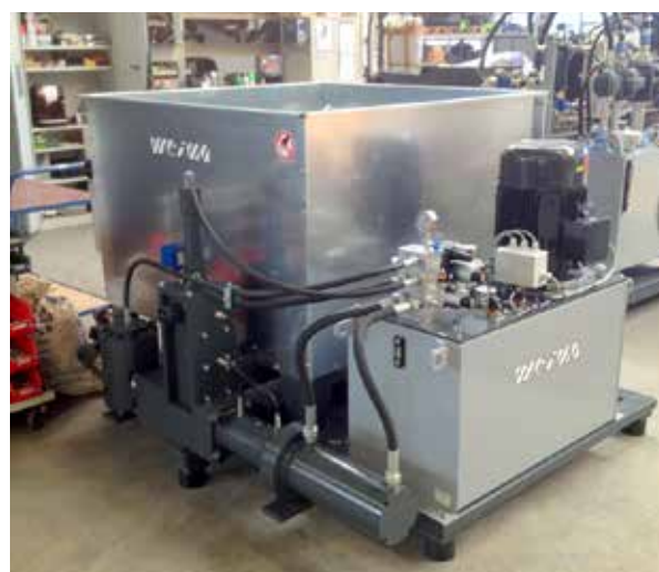
□ Stroj za proizvodnjo briketov iz plastičnih materialov Weima TH814 v tovarni Weima pred odpremo stranki SMITHERS OASIS ADRIA, Gradac, Slovenija
