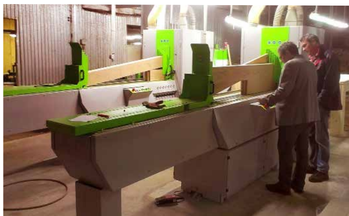
□ 2 tankorezna polnojarmenika Wintersteiger DSG Sonic pri stranki Hrast Strizivojna, Hrvaška
