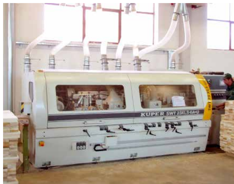
□ Štiristranski skobeljni stroj Kuper SWT pri stranki JAVUŠNIK , Vuzenica, Slovenija
