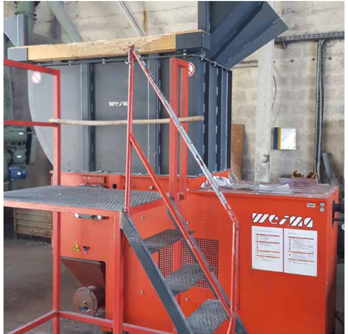
□ Stroj za drobljenje plastike Weima WLK 800 u tvornici DONIT Medvode, Slovenija
