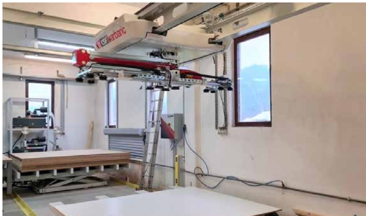
□ Automatsko skladište ploča Barbaric CSF u tvrtki MIZARSTVO ZUPANC, Selca, Slovenija
