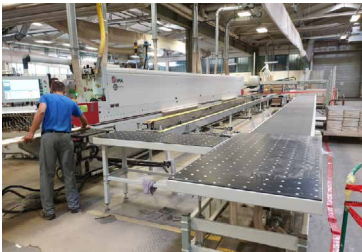
□ Uređaj za vraćanje i okretanje obratka Return RTS 02 u tvrtki PODGORJE Šentjernej, Slovenija.
