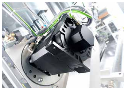
□ Servo motori s vodenim hlađenjem omogućavaju spori rad brusne trake
