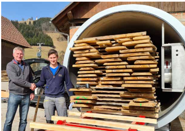
□ Vakuumska sušara Kronse der Eurovac KVT 1800 u firmi Žagarstvo Sedej, Rovte, Slovenija
