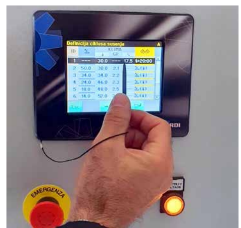
□ Sirio 9000 Plus s novim 10-inčnim zaslonom osjetljivom na dodir za jednostavno i učinkovito nadgledanje procesa sušenja
