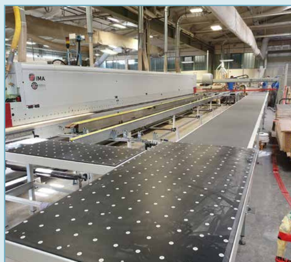
□ Kanterica Ima Novimat Systems/I/R75/950 u kombinaciji sa sustavom za vraćanje radnih komada BARBARIC Return 02 u tvornici PODGORJE Šentjernej, Slovenija
