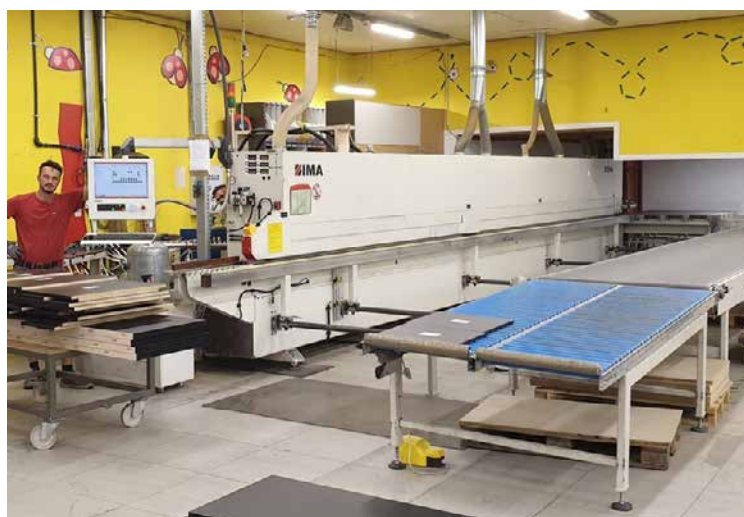
□ Stroj za obradu rubova Ima Novimat kod SIGMA PLUS Zagreb, Hrvatska
