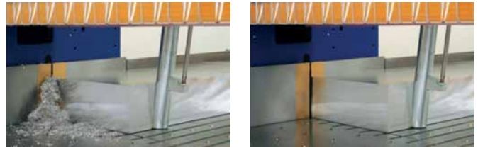
□ Piljenje bez (lijevo) i sa CLEAN-UP sustavom (desno)
