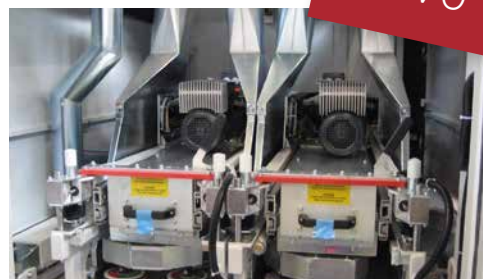
□ DB-S planetarna glava pruža izvanrednu kvalitetu površine (također za ulazni model brusilice HSM.2)
