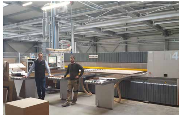
□ Pila za krojenje ploča Schelling fh4 i automatsko skladište ploča Barbaric u tvrtki POHIŠTVO ISKRA, Medvode, Slovenija
