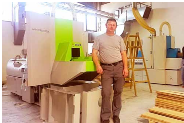
□ Tankorezni gater Wintersteiger DSG Sonic u tvornici BJELIN Ogulin, Hrvatska
