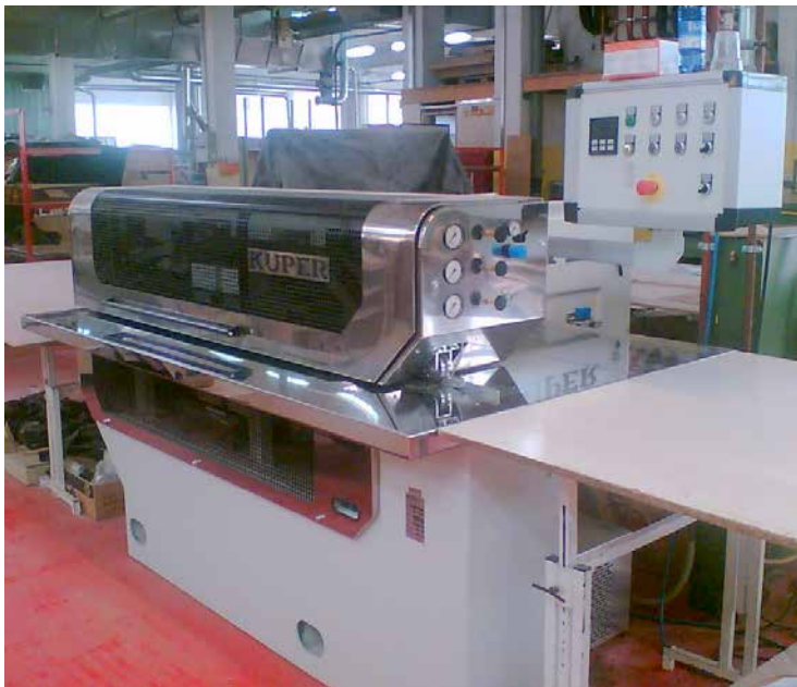
□ Stroj za spajanje furnira Kuper FLI 1000 kod Bobič Yacht Interior, Novo mesto, Slovenija
