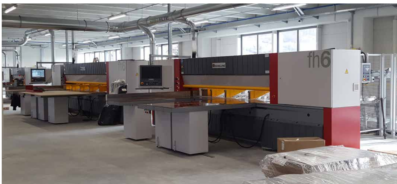
□ Strojevi za krojenje ploča s visokim performansima Schelling fh 6 kod IVERPANA, Donja Zelina, Hrvatska
