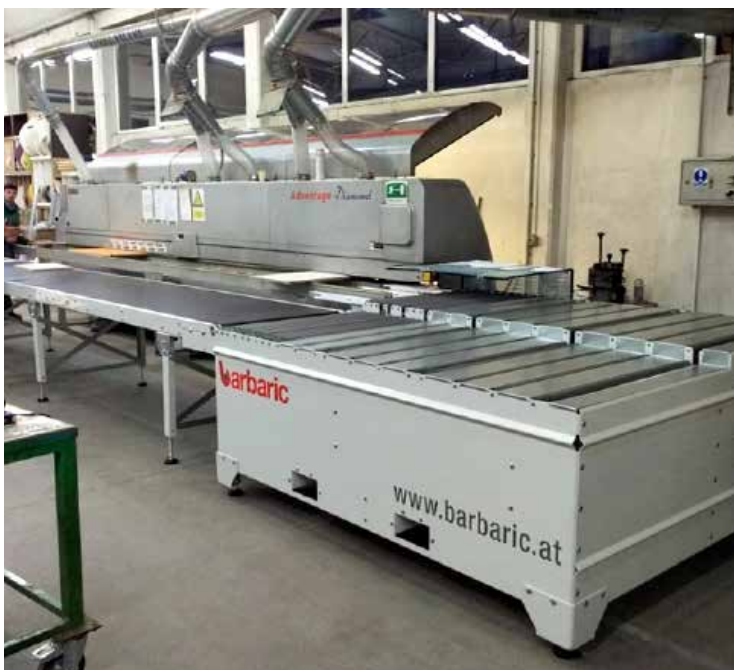
□ Uređaj za vraćanje obratka Barbaric Return 04 u tvornici IVERPAN Zagreb, Hrvatska.
