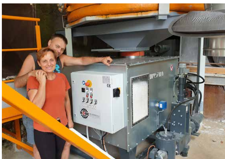
□ Stroj za izradu briketa iz stiropora Weima TH814 u tvornici KLEOPATRA Novo mesto, Slovenija
