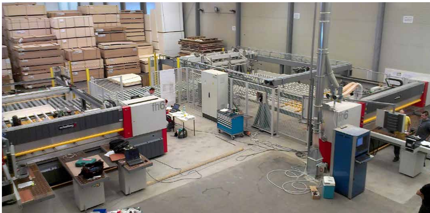
□ Linija za krojenje ploča Schelling (dve žagi FH 6) kod firme PODGORJE, Šentjernej, Slovenija
